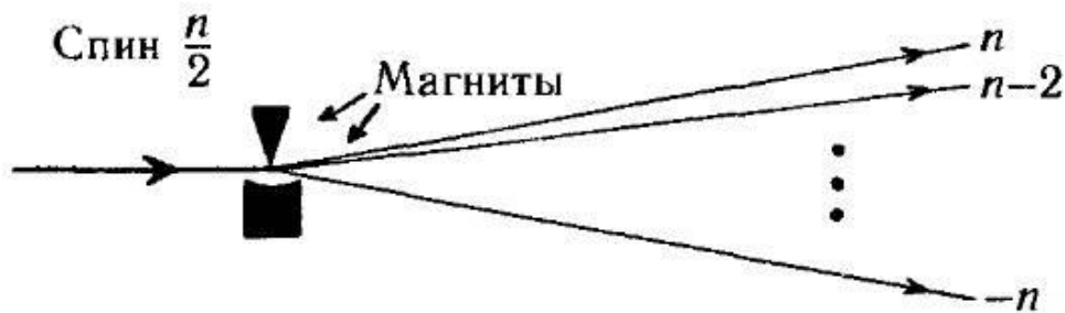
Рис. 5.20. Измерение спина с помощью установки Штерна–Герлаха. Для частицы со спином \frac{1}{2}n мы можем получить n + 1 возможных результатов, в зависимости от того, какая «доля» спина ориентирована в выбранном направлении.
