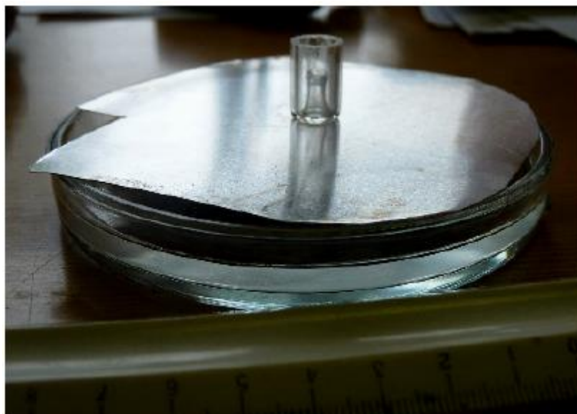
Рис. 1. Кристаллизатор с водой и Al-крышкой, тигель дериватографа для помещения пробы воды. 31
