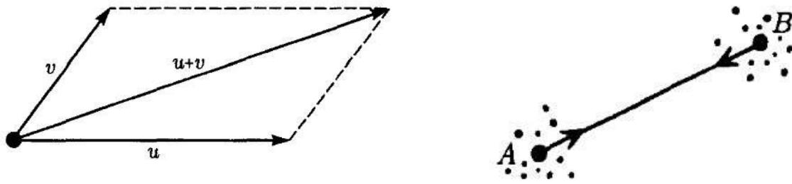
**Рис. 5.6.** Сложение векторов по правилу параллелограмма
