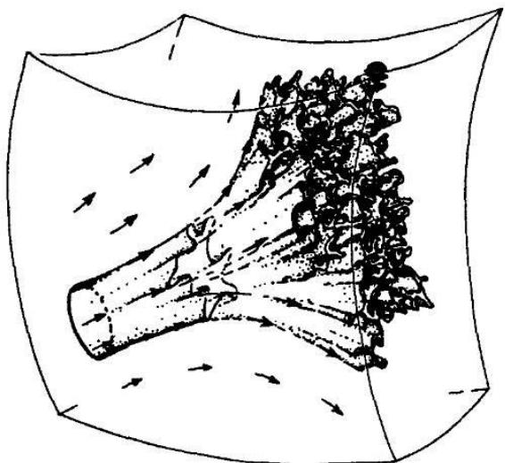
**Рис. 5.14.** Несмотря на то, что – согласно теореме Лиувилля – объем фазового пространства сохраняется постоянным, он, как правило, будет расплываться в результате чрезвычайно сложной эволюции системы во времени
