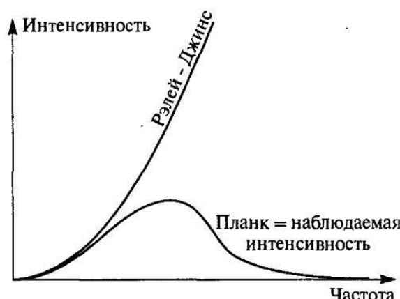
**Рис. 6.2.** Расхождение между интенсивностью излучения нагретого тела («абсолютно черного тела»), вычисленной в рамках классической теории, и наблюдаемой интенсивностью привели Планка к началам квантовой теории
