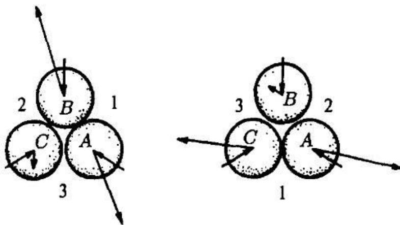
**Рис. 5.8.** Тройное соударение. Поведение частиц в результате столкновения существенно зависит от того, какие частицы сталкиваются первыми, поэтому исход столкновения не зависит непрерывным образом от начальных данных
