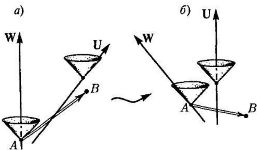
**Рис. 5.31.** Сигнал, который распространяется для наблюдателя **W** быстрее света, для наблюдателя **U** распространяется назад по времени. Ситуация справа (б) представляет собой ту же ситуацию, что и слева (а), только перерисованную с точки зрения наблюдателя **U**. (Эту перерисовку можно рассматривать как движение Пуанкаре. Сравните с рис. 5.21 – но здесь преобразование от (а) к (б) следует понимать в активном, а не в пассивном смысле.)
