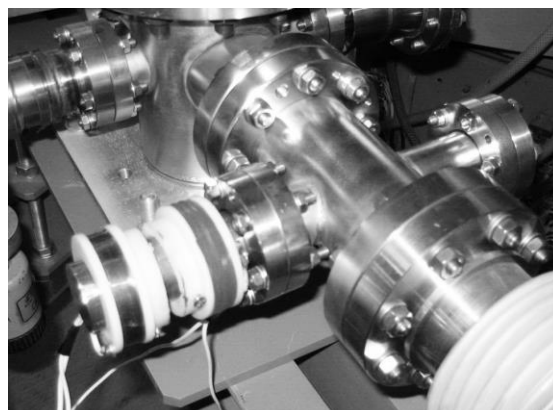
Рис. 2. Вакуумный узел устройства ввода-вывода стеклянной пластинки.
